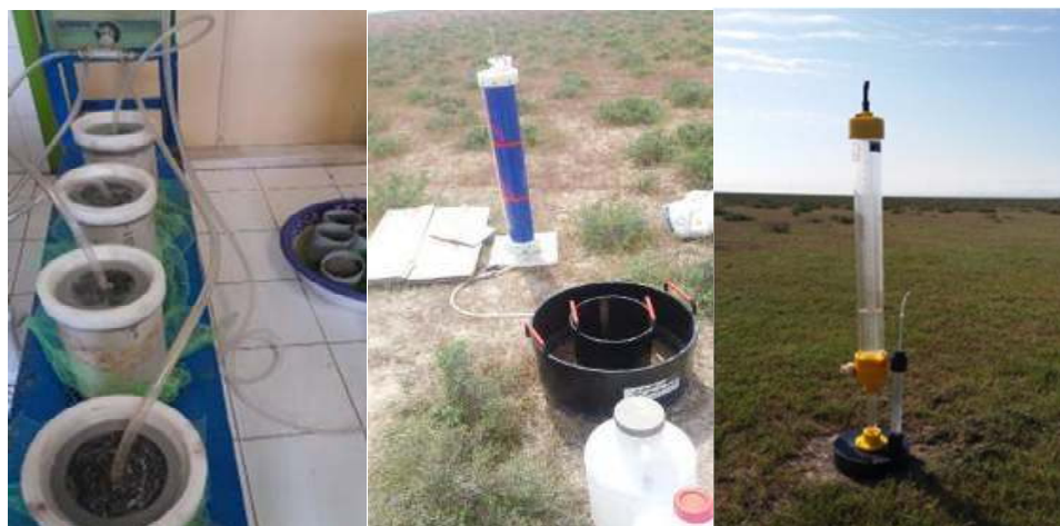
دستگاه نفوذسنج مکشی مرتع گوبگلجه مورخه ۱۳۹۷/۰۱/۰۲ دیل‌رینگ با هد ثابت مرتع قره قره‌قزیزگ مورخه ۱۳۹۷/۰۱/۲۴ در آزمایشگاه- مورخه ۱۳۹۷/۰۲/۱۱ اندازه‌گیری هدایت هیدرولیکی با هد ثابت شکل ۳: دستگاه‌های اندازه‌گیری هدایت هیدرولیکی خاک
